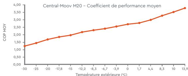
RNCAN et le gouvernement du Canada définissent le coefficient de performance (COP) d'une thermopompe comme le rapport entre le taux auquel la thermopompe transfère l'énergie thermique (en kW) et la quantité d'énergie électrique requise pour effectuer le pompage (en kW). Par exemple, si une thermopompe utilise 1 kW d'énergie électrique pour transférer 3 kW de chaleur, le COP sera de 3.
